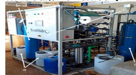
Cuatro sistemas evaluados y comparados: ecológico a) con RO (OGRO) y b) con IX (OGIX); y convencional d) con RO (CGRO) y con IX (CGIX)
